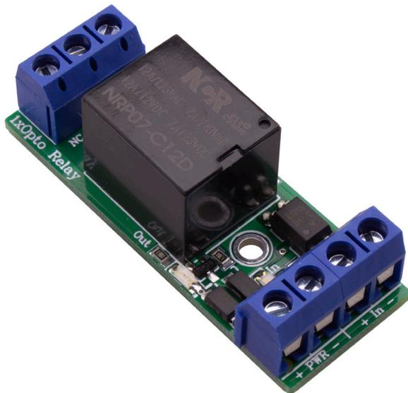
Устройството представлява универсален галванично разделен входно-изходен модул с един релеен изход и светодиодна индикация. Подходящ за управление с логически нива 3.3V и 5V за управление от изходи на микроконтролер.
