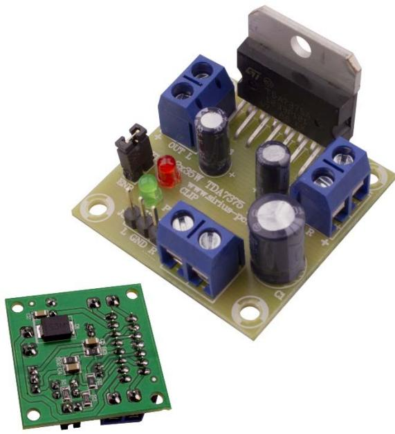
Устройството представлява двуканален мостов аудио усилвател изграден на базата на интегрална схема TDA7375. Отличителните черти на устройството са: защита от мрежов шум, добро звучене, без нужда от предусилвател, еднополярно захранване, подходящ за акумулатор 12V и лесен за монтаж.
