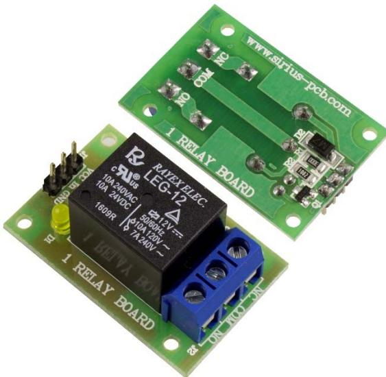
Модулът е изграден от електромагнитно реле, работещо на 12V, управлявано от NPN транзистор, монтирани върху платка. Модулът намира приложение, като електронен ключ, прекъсвач, при управление на мощни консуматори (вентилатори, мотори, лампи, мощни светодиоди и др.) от микроконтролер и др.
