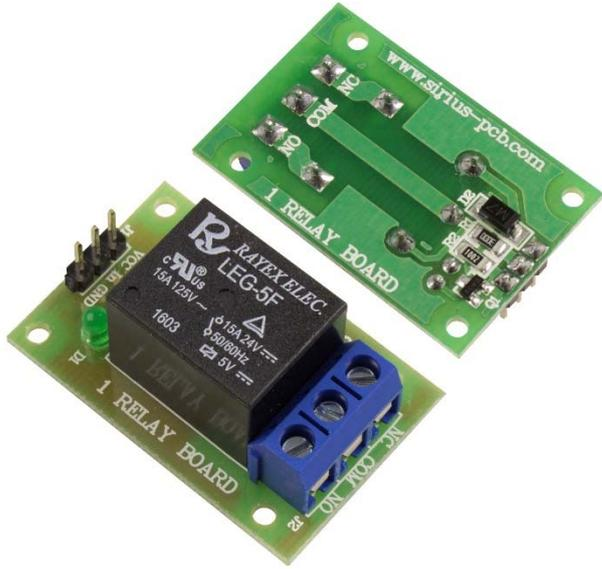
Модулът е изграден от електромагнитно реле, работещо на 5V, управлявано от NPN транзистор, монтирани върху платка. Модулът намира приложение, като електронен ключ, прекъсвач, при управление на мощни консуматори (вентилатори, мотори, лампи, мощни светодиоди и др.) от микроконтролер и др.
